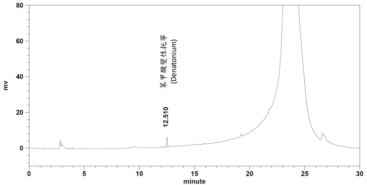
圖一、苯甲酸變性托寧參考物質圖譜(約 1.5ppm)
